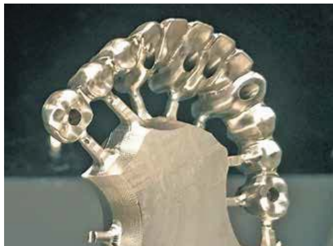
Abb. 5: Gefrästes Brückengerüst mit abgewinkelten Schraubenkanälen für das BHS30 System (seramic CAM, Bottrop).
